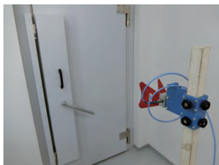
ダブルリッジガイド ホーンアンテナ (平面波1GHz~18GHz)
