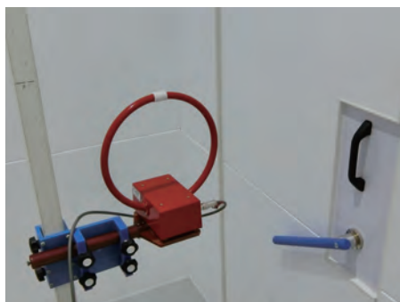
ループアンテナ (磁界9kHz~30MHz)
