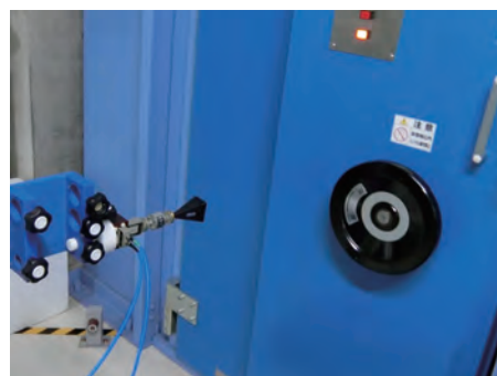
標準ゲインホーンアンテナ (平面波18GHz~60GHz)
