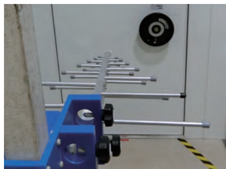
ログペリオディックアンテナ (平面波300MHz~1GHz)
