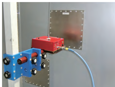
ロッドアンテナ (電界9kHz~30MHz)
